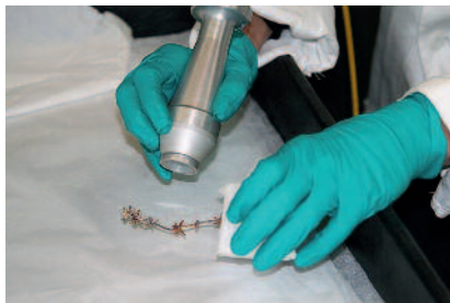
16 Anwendung des Lasers auf einem rekonstruierten Naturabguss
