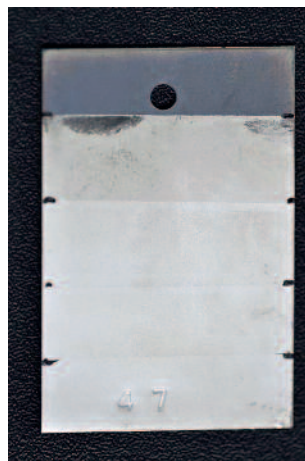
18 Testplättchen nach mehrfacher Plasma- behandlung
