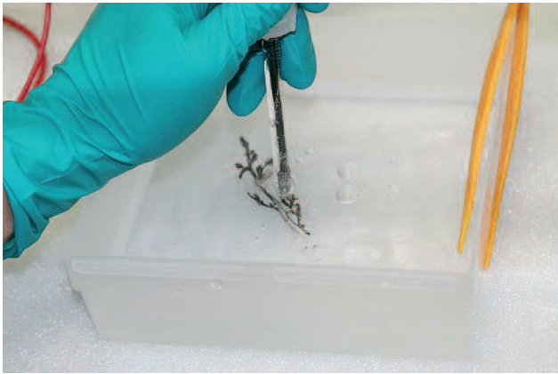
13 Elektrolytische Behandlung eines Naturabgusses mit dem Absaugstift
