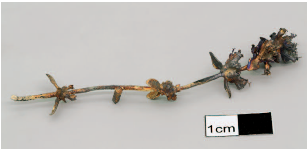
7 Rekonstruierter Naturabguss nach dem künstlichen Erzeu- gen der Silbersulfidschicht
