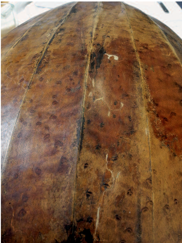
12 Mit Kitt gefüllte Wurmfraßgänge
