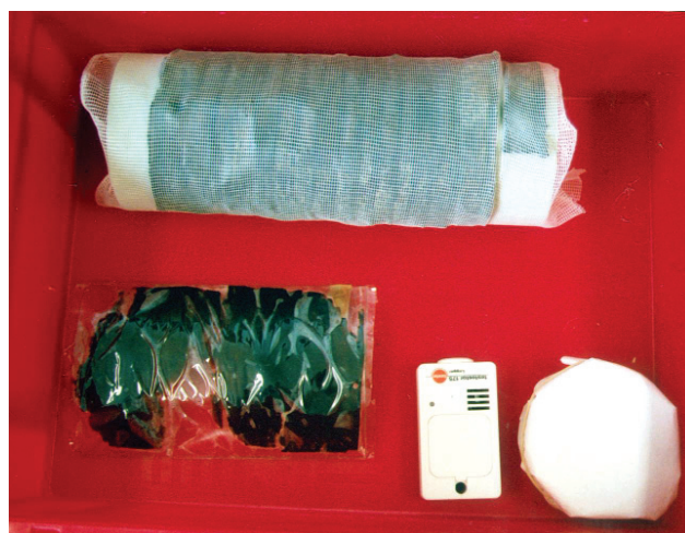
6 Blick in die Klimakiste: oben das Leder mit Gazeumwicklung, unten das Horn mit Folienabdeckung, daneben der Datenlogger, daneben die Schale mit der Salzlösung und Gore-Tex-Abdeckung
