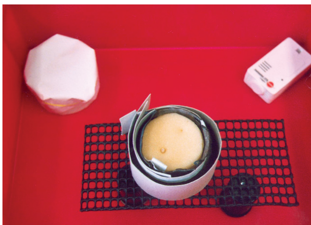
7 Die Abzugshaube ist mit Hilfe von Pappstreifen um den Schaumblock gelegt
