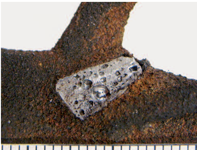
11 Luft einschließen in Lotstelle
