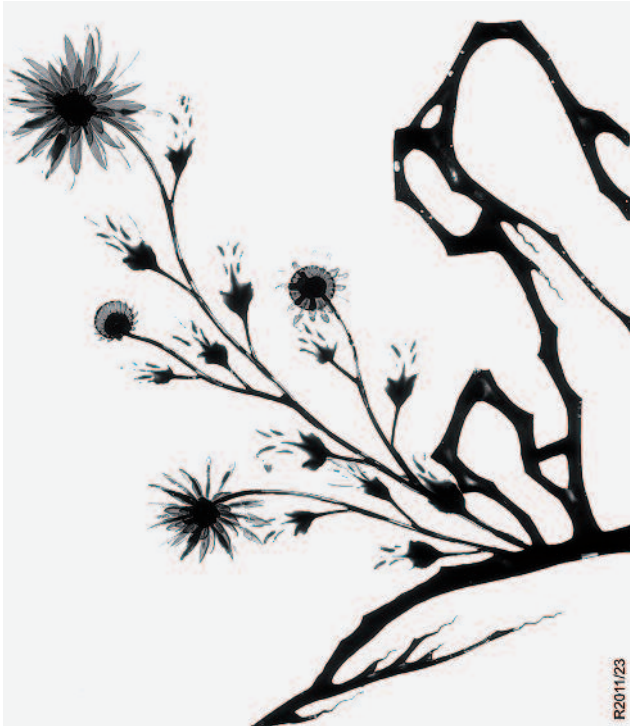
4 Invertierte Röntgenaufnahme des Bildes Chrysantheme und Fels , bei 100kV
