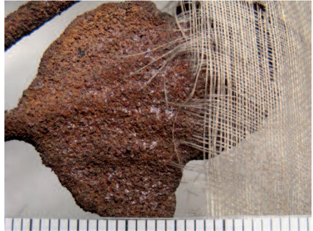
10 Korrodierte Beschichtung und gerissene Seidenbespannung
