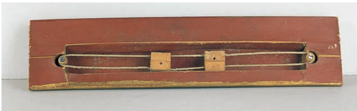
8 Rückseite eines heraus- genommenen Mittelteils mit einem Rollensystem
