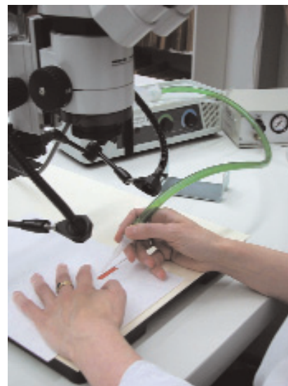
12 Festigungsbereich, der unter dem Mikroskop bearbeitet wird.
