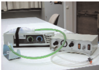
10 Umgebauter Ultraschallvernebler, Dosiergerät und Durchlaufbahn.
