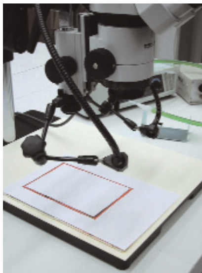
11 Mit Maske abgedeckte Seite. Nur der rote Rahmen bleibt für die Aerosolfestigung frei.
