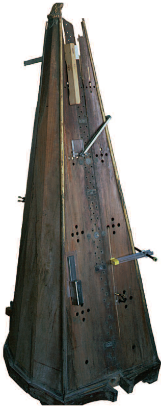
9 Ausspannung und Verleimungen an der Resonanzdecke; im linken unteren Bereich aufgesetzte Magnete
