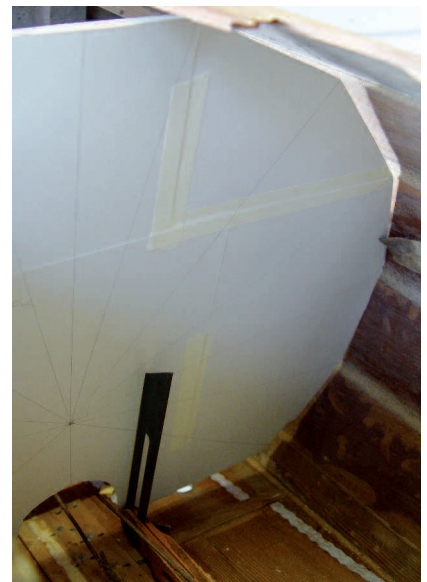
12 In den Resonanzraum gesetzte Schablone zur Ausrichtung der Korpuspäne (Harfe liegend, Resonanzdecke unten)
