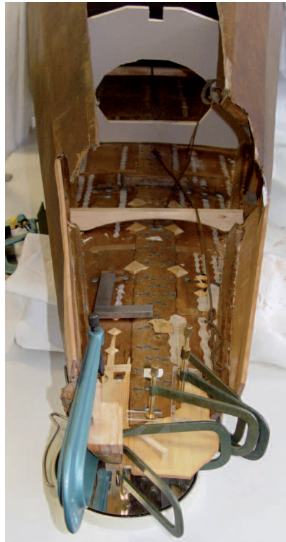
13 Resonanzkörper liegend, Blick aus der Richtung des Oberklotzes, während der Bearbeitung
