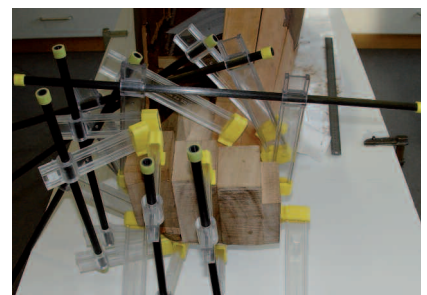
15 Anpassen der Korpuspäne und des Oberklotzes
