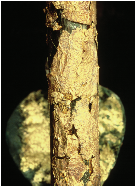
1 Schadensbefund der sich ablösenden Goldfolie
