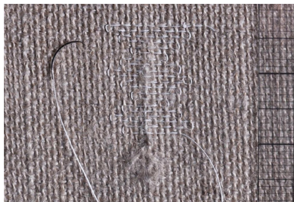
3 Beispiel einer Rissvernahtung mit PTFE-Nahtmaterial (Monofilament, Nadel 3/8, Länge 9 mm) zur Rissverschluss; nach dem Ausrichten und Zusammenführen der Rissränder im Zuge der Vernahtung kann eine Einzelfadenverklebung durchgeführt werden.
