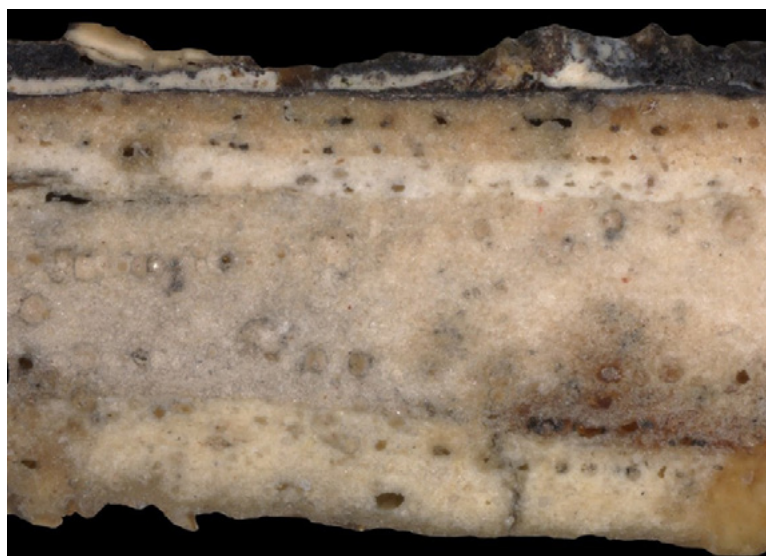
6 Heiliger Rochus: Der Anschliff zeigt homogenen Gips als Malgrund, in der Bolusschicht vorrangig Fe und Al, darüber eine Vergoldung
