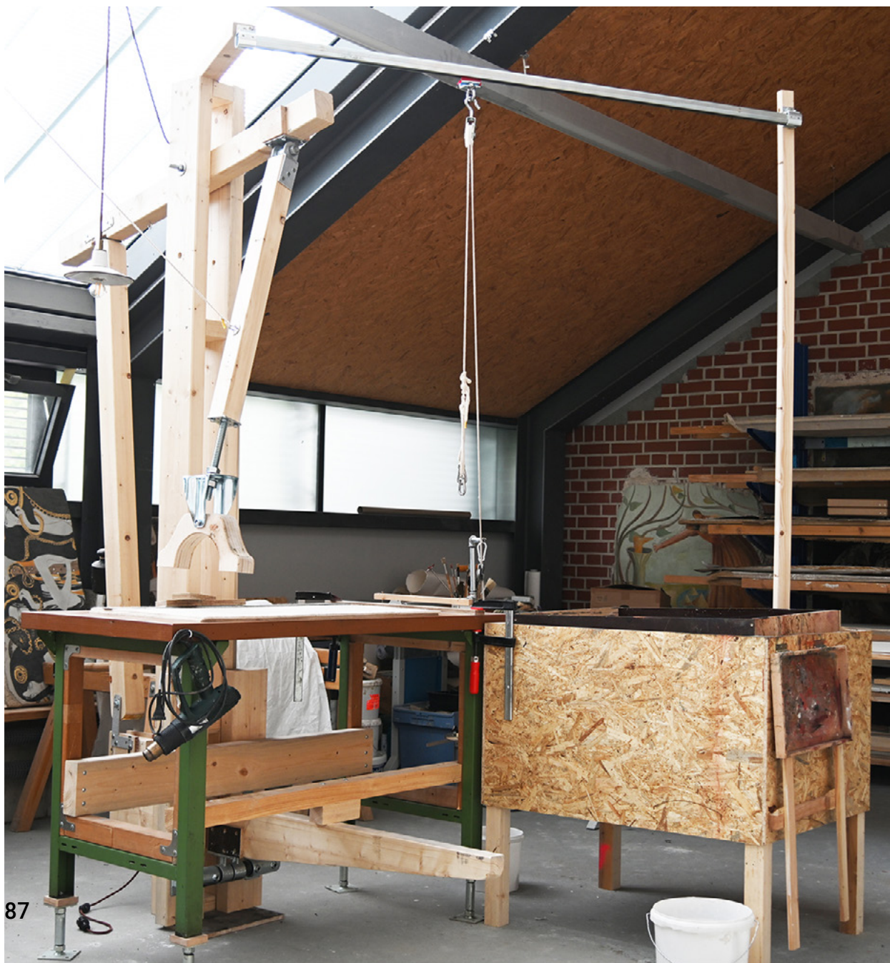
5 Rekonstruierter englischer Drucktisch für Handmodelldruck mit Farbkasten
