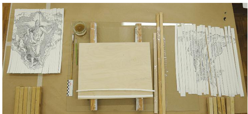
20 Aufleimen der vorbereiteten Lamellen auf eine Holzplatte
