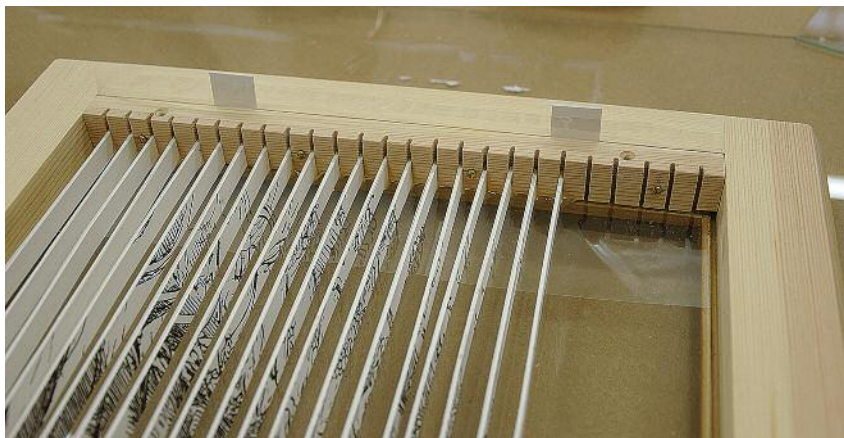
15 Einkleben der Lamellenenden in die Zahnleiste
