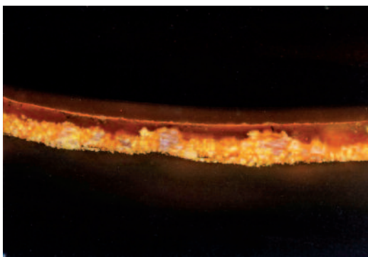
12 Lobenigk-Uhr, Querschliff einer Farbscholle der Trommelstöcke: Auf der originalen Malschicht, einer Ausmischung aus Auri- pigment und Realgar, liegt ein originaler Firnis. Auf diesem befindet sich eine neuzeitliche Retusche mit einem Zaponlack- überzug. Unter UV-Lichtanregung zeigen die beiden Überzüge unterschiedliches Fluoreszenz- verhalten.
