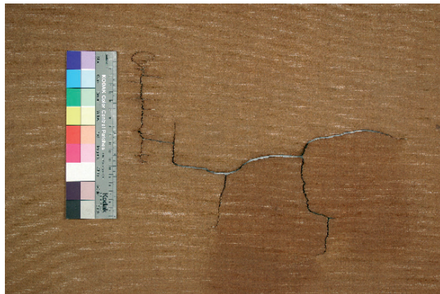
6 Detailansicht verzweigter Riss, Vorderseite, Vorzustand
