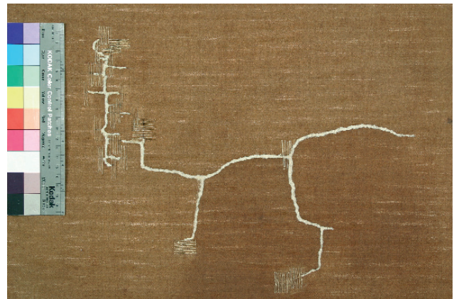
8 Detailansicht verzweigter Riss, Vorderseite, während der Bearbeitung
