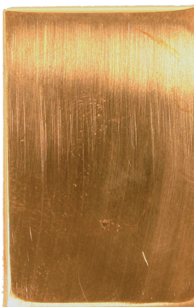
14 Bronzeblech vor (links) und nach 24 Stunden in Na 3 -Citrat (rechts)
