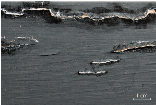
11 Nach dem Fräsen, Einbringen des Festigungsmittels und Entfernen der Japanpapierstreifen
