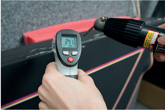
9 Anwendung des Heißluftgeräts und Wärmekontrolle
