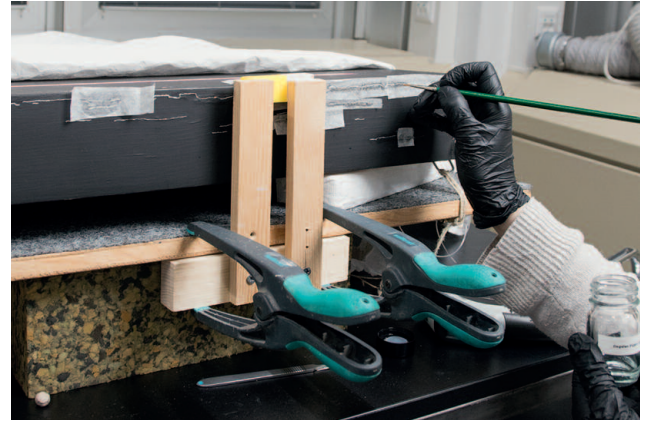
10 Niederlegen der Schollen und Trock- nung unter Druck
