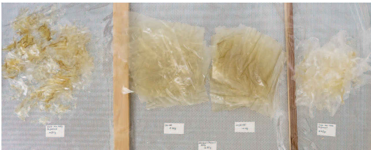
6 Aus je 100 g Ausgangsmaterial wurden 81 g Kalbspergamentleim, 42 g Ziegenpergamentleim und 90 g Pergamentleim aus dem Pulver gewonnen
