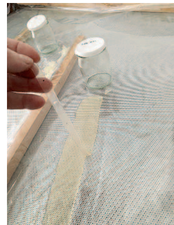
10 Auf dem Heiztisch dünn ausgegossene Leimfilme
