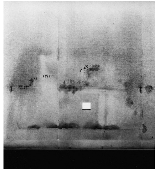
5 Wandbespannung hinter Tizians „Nymphe und Schäfer“, Abdruck des Zierrahmens in der unteren Hälfte, Abdruck des Keilrahmens und dunkle Wasserflecken aus mehreren Jahren zeugen von intensiver Kondensation, Zustand 1990.
