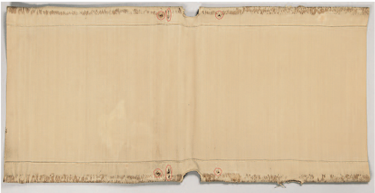
10 Stuhlbespannung, Rückseite, Vorzustand, je drei gegenüberliegende Gewebeeinschnitte rot markiert, rundes Lochpaar links für die Aussparungen für den unteren Spannbügel
