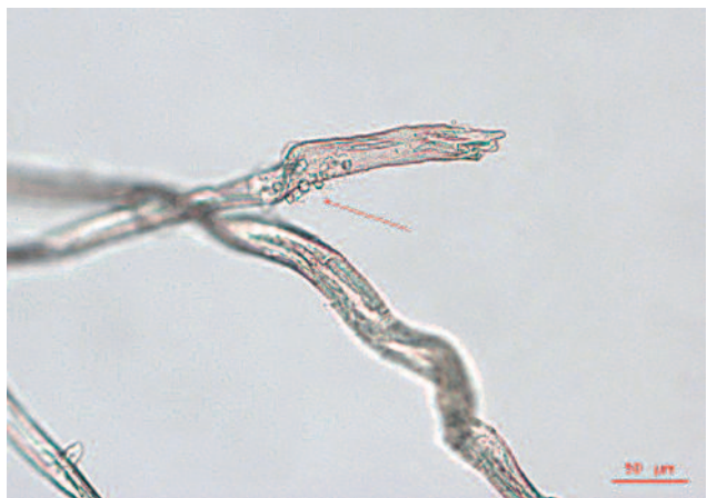
5 Faserprobe, Laugenquelltest, obere Faser mit Korrosionsprodukten, viele Kerben bedeuten starke Schädigung, untere Faser ohne Korrosion, geringe Schädigung, Durchlichtmikroskop
