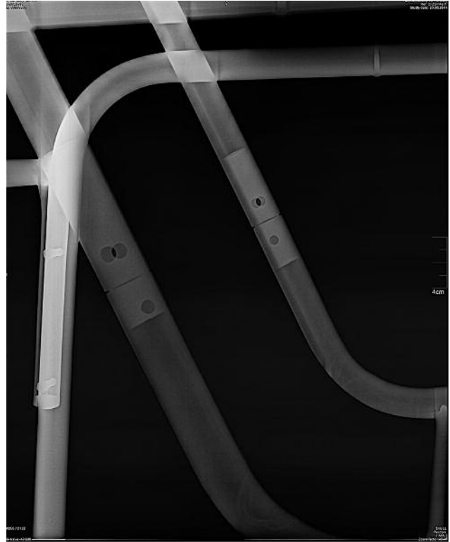
9 Das Röntgenbild der Rückenlehne zeigt die Position der Steckmuffen ohne Schraubverbindung
