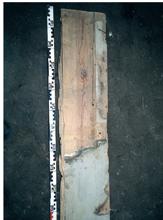
9 Detailaufnahme eines Brettes des linken, vertikalen Konstruktionselements der Rückwand des Velgaster Kanzelaltars: Die Konturen von Postament, Grundplatte und Säulenbasis markieren sich ebenso wie ein Fruchtgehänge des linken, seitlichen Anbaus.
