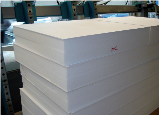
7 Gestapelte Plinthen aus jeweils zwei Platten Ethafoam® mit einer Decklage aus Museumskarton vor dem Beschnitt auf das Endmaß
