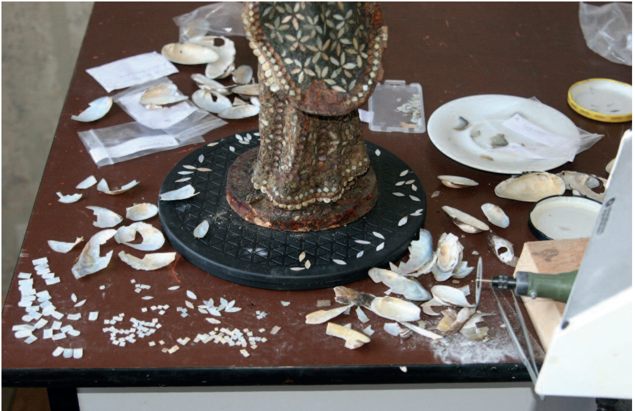
13 Zuschneiden und Anpassen der Perlmutscheibchen für die Ergänzungen. Es wurde mit einer Diamantschleifscheibe und mobiler Absauganlage gearbeitet.
