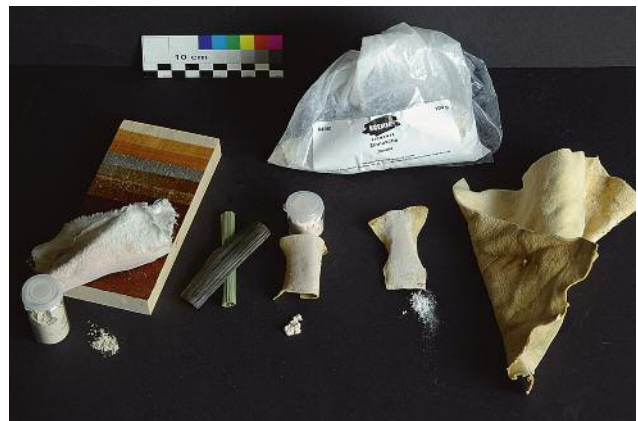
27 Die Schleif- und Poliermaterialien von grob zu fein: Bimssteinpulver, Schachtelhalm, Tripelpulver, Zinnasche und Lederlappen
