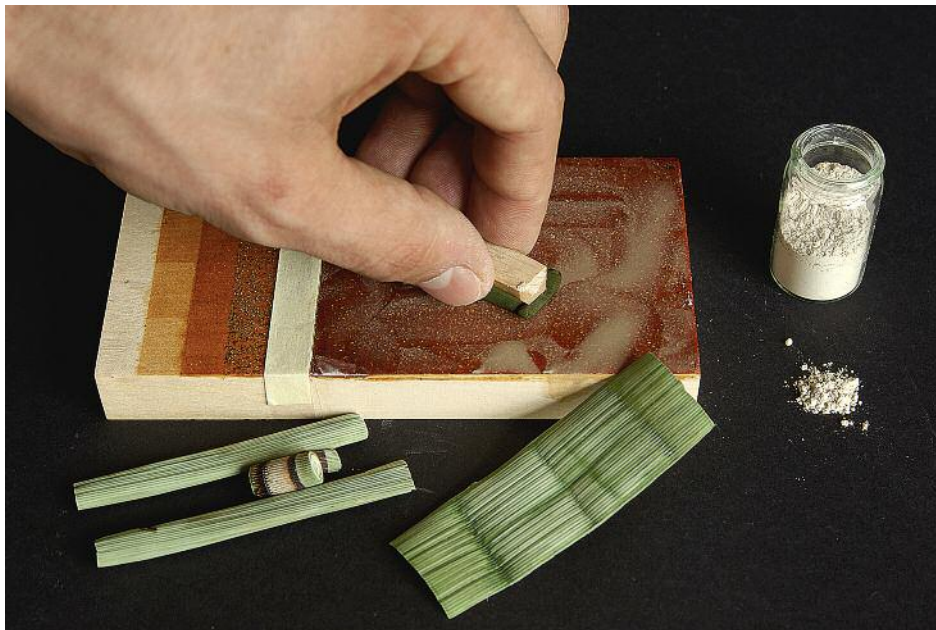
24 Schleifen mit wässriger Bimsmehlpaste, Schachtelhalm und Holzklötzchen bei Tafel 3, Q1 Kunckel
