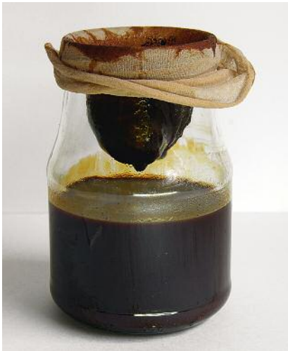
15 Filtern eines Lackes nach Rezept von Q4A Locher aus gereinigtem Stocklack in Ethanol mithilfe eines Nyronsiebes
