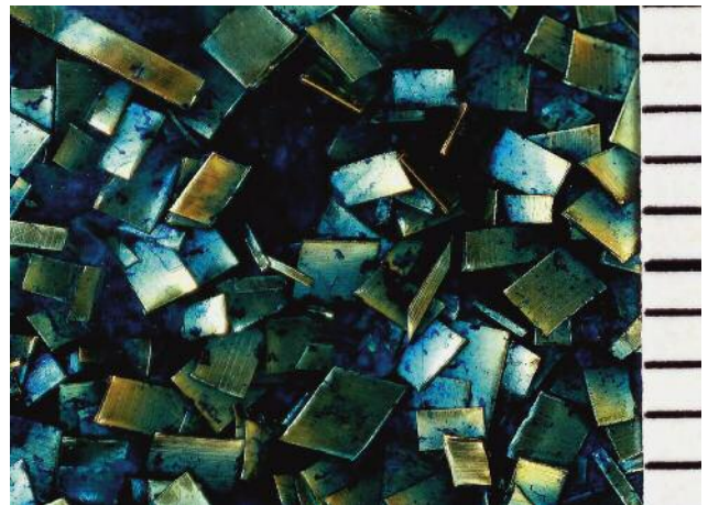
19 Mikroskopaufnahme des Aventurinlackes aus Tafel 20
