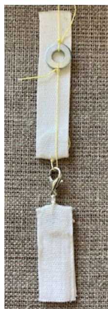
16 Modifizierter Zugstreifen mit Karabiner, eingehängt in die Schlaufe des oberen, um 180° gedrehten Zugstreifens (Modell)
