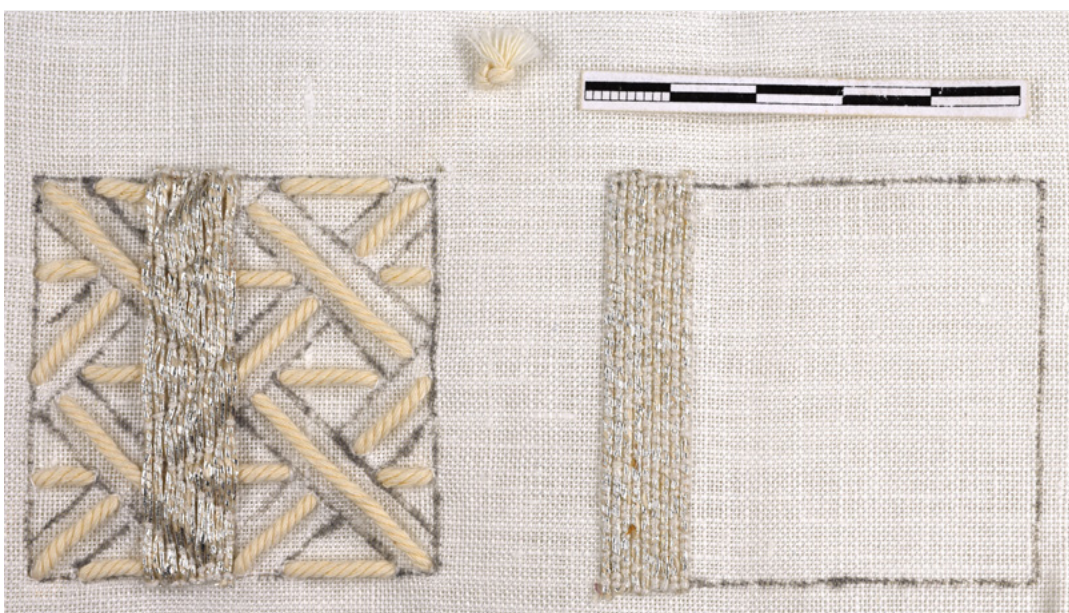
12 Arbeitsprobe einer Anlegestickerei mit dem hergestellten Häutchensilberfaden
