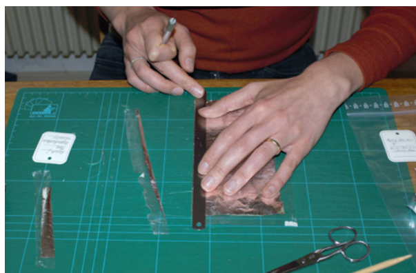
4 Herstellung der Häutchengoldfäden: Zuschnitt der metallisierten Darmhäute mit dem Skalpell
