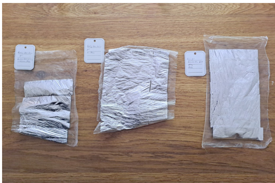
3 Goldschlägerhäutchen mit Blattmetallaufgabe: einseitig aufgetragener Kalbspergamentleim (links), ohne Klebemittel (Mitte), beidseitig aufgetragener Ziegenpergamentleim (rechts)
