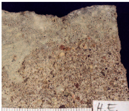
12 Ludwig Mies van der Rohe, Berlin Niciassee, Dreilindenstraße 30, Haus Eichstaedt (1921–1923), Putzprobe: geriebener rötlich-gelber Putzmörtel (mit Ziegelsplintern und teilweise erhaltener Patina). Studienarbeit HAWK Hildesheim, Stefanie Dannenfeldt, Vanessa Knappe, Natalie Schaack
