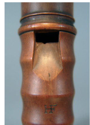
6 Riss im Labium der Blockflöte von Kinsecker
