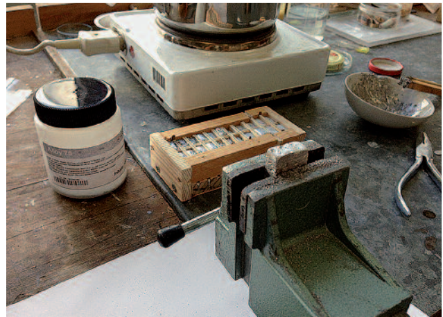
14 Gussform und Nachbearbeitung der neuen Gewichte
