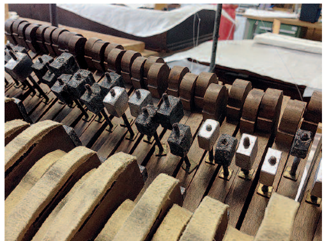
15 Blick auf die Mechanik mit den gerei- nigten und den ergänzten Gewichten
