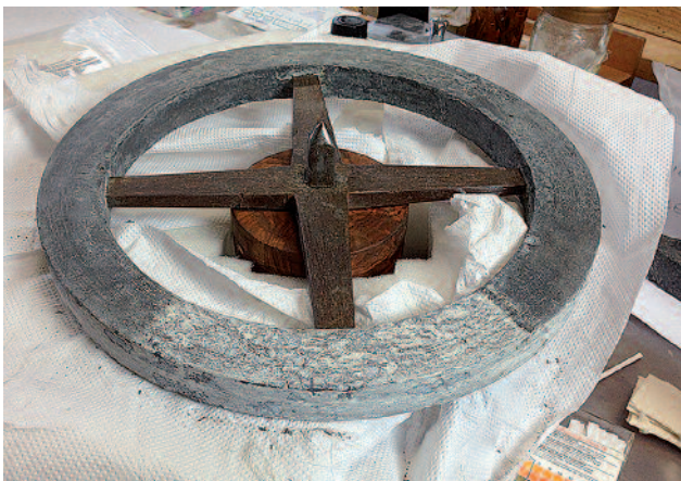
6 Mechanische Freilegung des bleiernen Schwungrades
