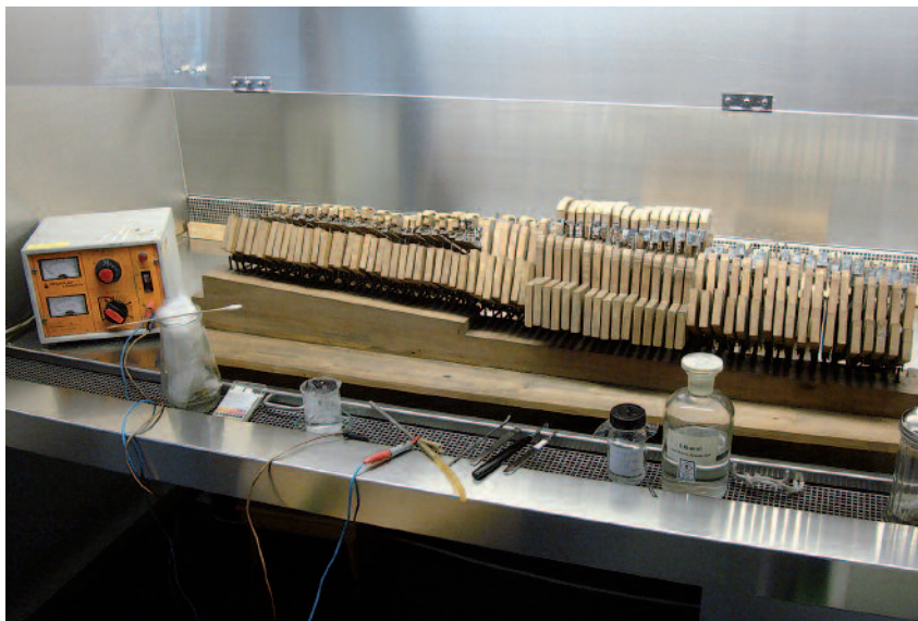
5 Arbeitsplatz für die Entfernung und Bearbeitung der Korrosionsprodukte
