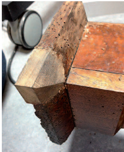
9 Anobienschaden am Fuß des Instrumentengehäuses
