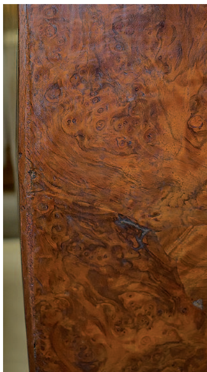
11, 12 Mit Kork gefüllter Spalt zwischen Seiten- und Rückwand (vor und nach der Retusche)
