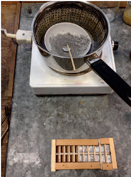
13 Schmelzen der Ersatzlegierung für die zu ergänzenden Bleigewichte
