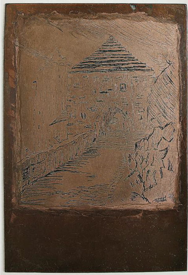
Eine gestochene und eine geätzte Kupferplatte mit tief liegenden Motiven zur Abformung der Hauchbildfolien
