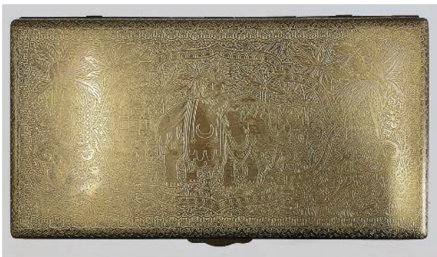
Kupferkiste mit tiefliegendem Motiv zur Abformung der Hauchbildfolien
