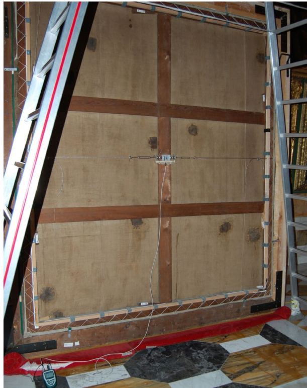
4 Zugkraftsensor auf der Bildrückseite eines großen Leinwandgemäldes in der Bildergalerie des Schloss Sanssouci; Rückseite des Gemäldes: Rubens-Werkstatt, Kardinalinfant Ferdinand von Spanien und Portugal (1609–1641) zu Pferde, nach 1635
