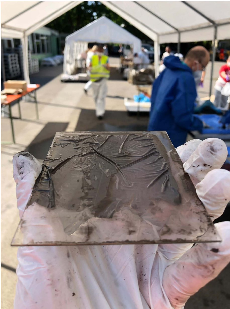
11 Flächige Ablösung der Emulsionsschicht eines Glasplattennegativs
