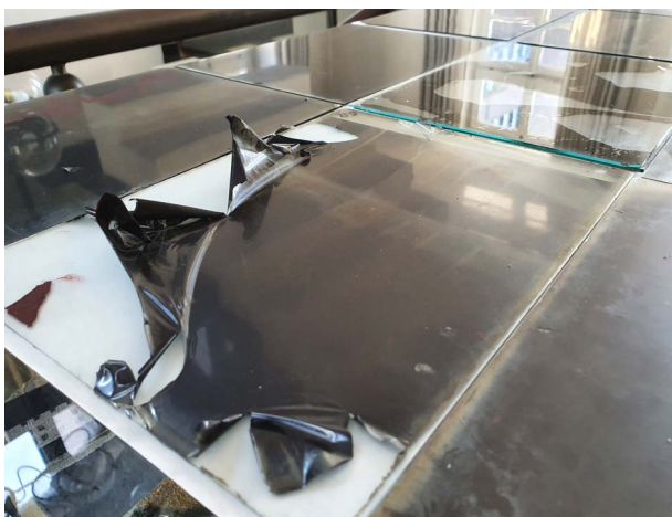
7 Partielle Bildschichtablösung und -verformung eines Glasnegativs
