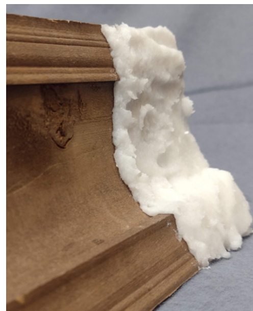
2 Auftrag der Gelkomresse auf ein Profil – die Masse passt sich den Unebenheiten an und haftet auch an den senkrechten Flächen.
