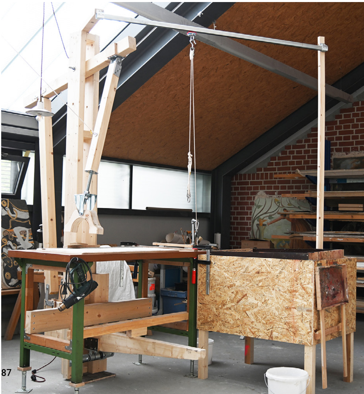
5 Rekonstruierter englischer Drucktisch für Handmodelldruck mit Farbkasten
