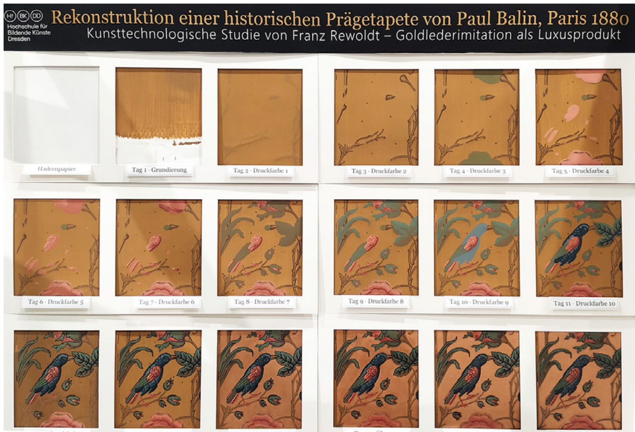
14 Präsentationsform der Technologieabwicklung aller Arbeitsschritte zur Herstellung einer Papier-Goldlederimitationstapete nach Paul Balin
