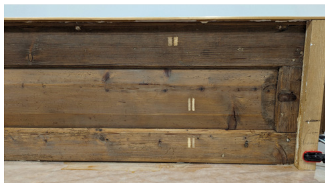
9 Nachzustand – Nach der Behandlung mit der Aceton/Methanol 4/1 + \gamma -Alumina Gelkompressse)
