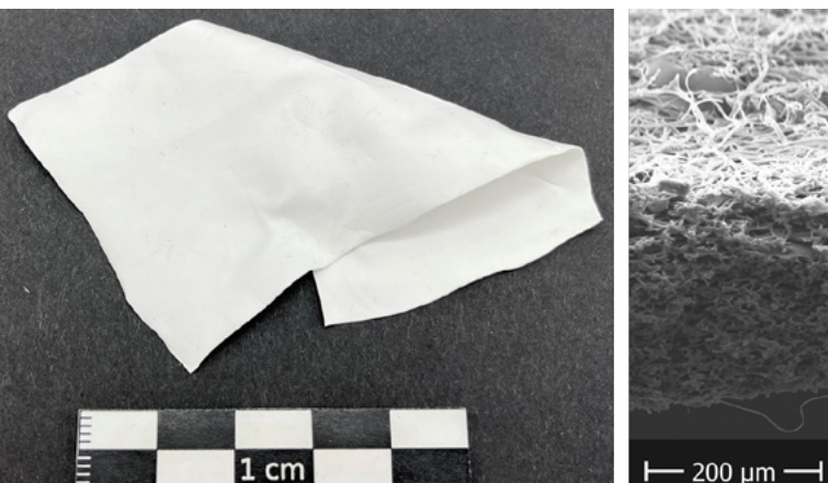
13 Beispiel eines vergleichsweise dicken, elektrogenesponnenen PCL-Vlieses (links); der Griff des Textils ist ausgesprochen weich bei hoher Drapierfähigkeit, bedingt durch den feinfaserigen Aufbau und die große Oberfläche, wie im REM-Detail erkennbar (rechts).
