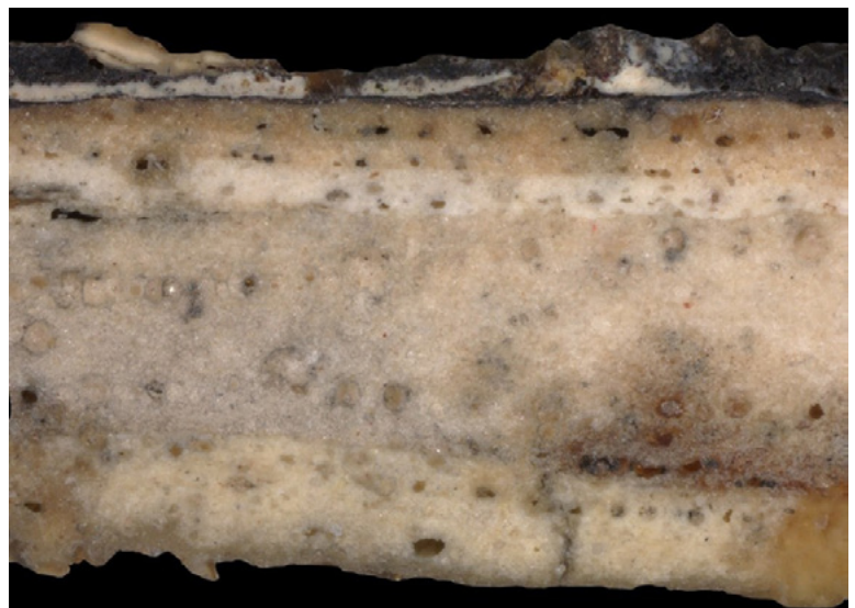
6 Heiliger Rochus: Der Anschliff zeigt homogenen Gips als Malgrund, in der Bolusschicht vorrangig Fe und Al, darüber eine Vergoldung
