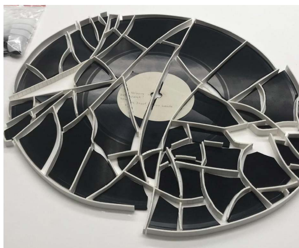
3 Beispiel für das Puzzeln von Teilen stark fragmentierter Schellackplatten
