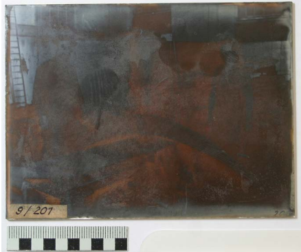
6 Glasplattennegativ, Vorzustand, Schichtseite mit starker Verschmutzung
