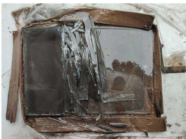
9 Gebrochene Glasplatten in ihrer aufgeweichten Originalverpackung
