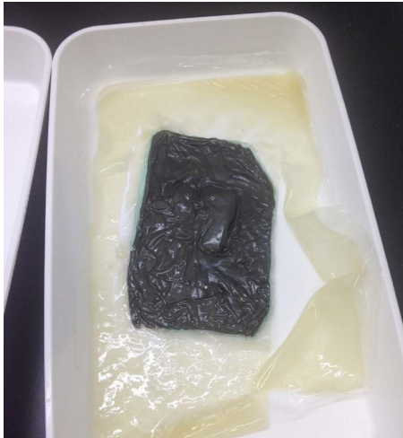
11 Zwischen Tag 5 und 6 entsteht ein einheitlicher Film im Bad, das Negativ muss herausgeschnitten werden und wird in einem frischen MEK-Bad wieder angelöst.
