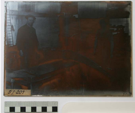
7 Glasplattennegativ, Nachzustand, die Oberflächenverschmutzung konnte vollständig entfernt werden
