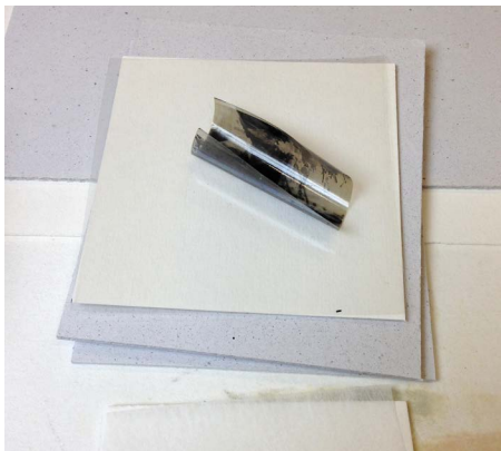
16 Objekt 06 (CN) Einrollen der Fotoemulsionsschicht beim Verpacken
