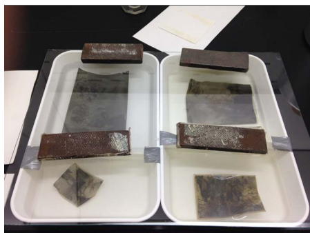
5 Die Objekte im MEK-Bad (von links oben nach rechts unten: Objekt 16 (CN), 09 (CN), 20 (CN), 06 (CN))
