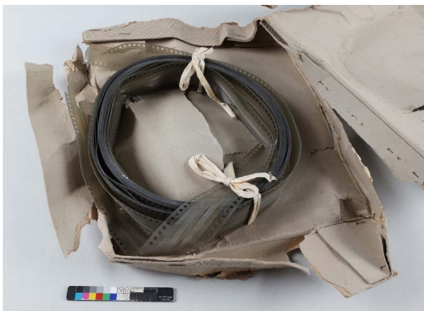
4 Schallband für ein Tefiphon aus dem Jahr 1939 in seiner Originalverpackung. Das Trägermaterial ist Cellulosenitrat. Der perforierte 35-mm-Streifen enthält Tonaufnahmen.
