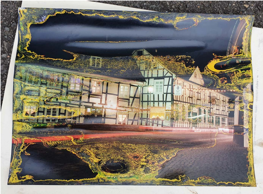
6 Wasserschaden an einer Farbfotografie
