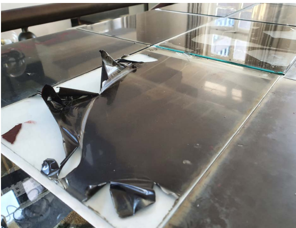
7 Partielle Bildschichtablösung und -verformung eines Glasnegativs
