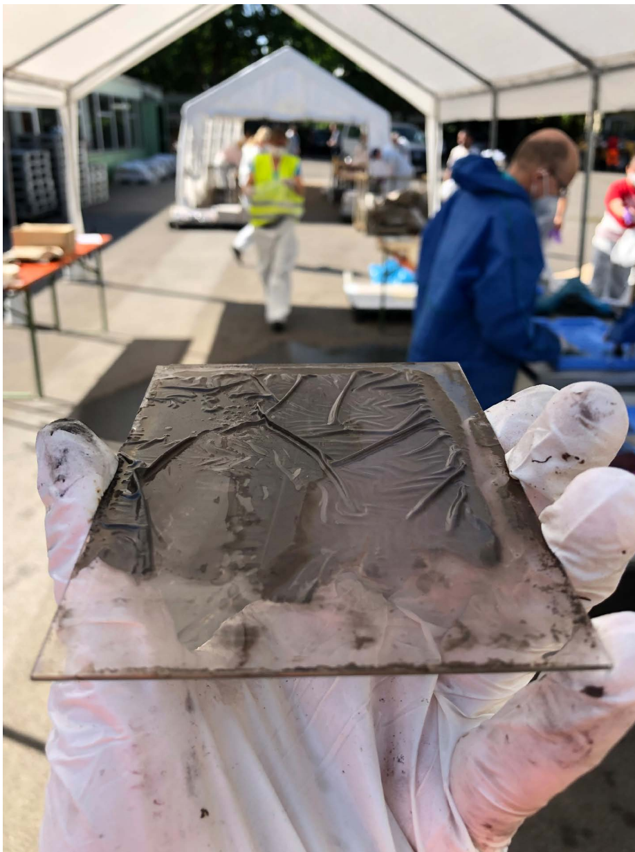
11 Flächige Ablösung der Emulsionsschicht eines Glasplattennegativs
