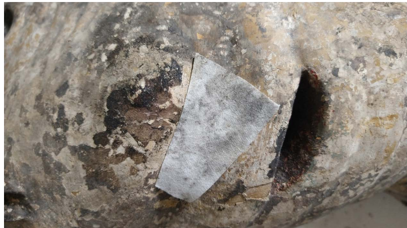
13 Abgenommene Evolonkomresse nach dem ersten Reinigungsdurchgang
