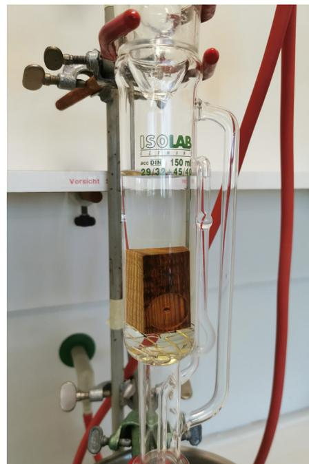
2 Labor-Soxhlet-Aufsatz mit Vollholzprüfkörper
