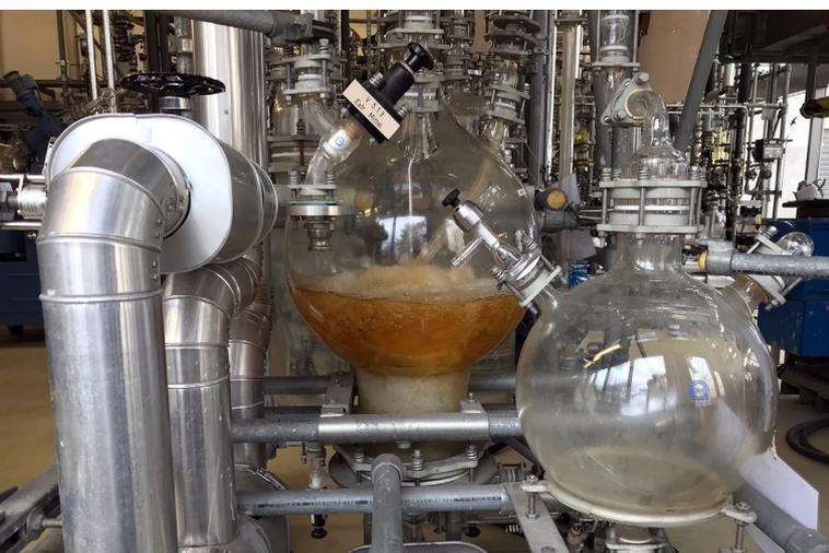
7 50 Liter-Kolben der Soxhlet-Apparatur im bbz Chemie Berlin mit Extraktionsmittel in Betrieb (braune Färbung durch extrahiertes Holzschutzmittel)
