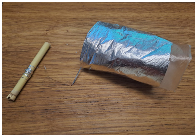
8 Herstellung eines möglichst langen Membranstreifens mittels Zylinder aus versilberter Goldschlägerhaut, teilweise auf eine Spule gewickelt
