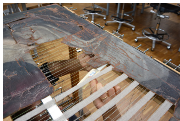
11 Temporäre Sicherung der großen Fehlstelle mit Gewebestreifen und tesa® Powerstrips
