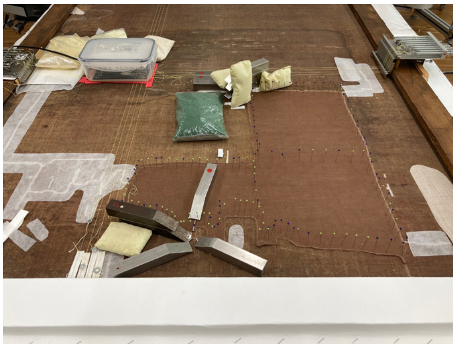
20 Zustand nach Fixierung der Intarsie mittels Nadeln und bereits erfolgter Verklebung an der oberen und rechten Kante
