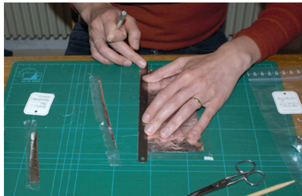
4 Herstellung der Häutchengoldfäden: Zuschnitt der metallisierten Darmhäute mit dem Skalpell
