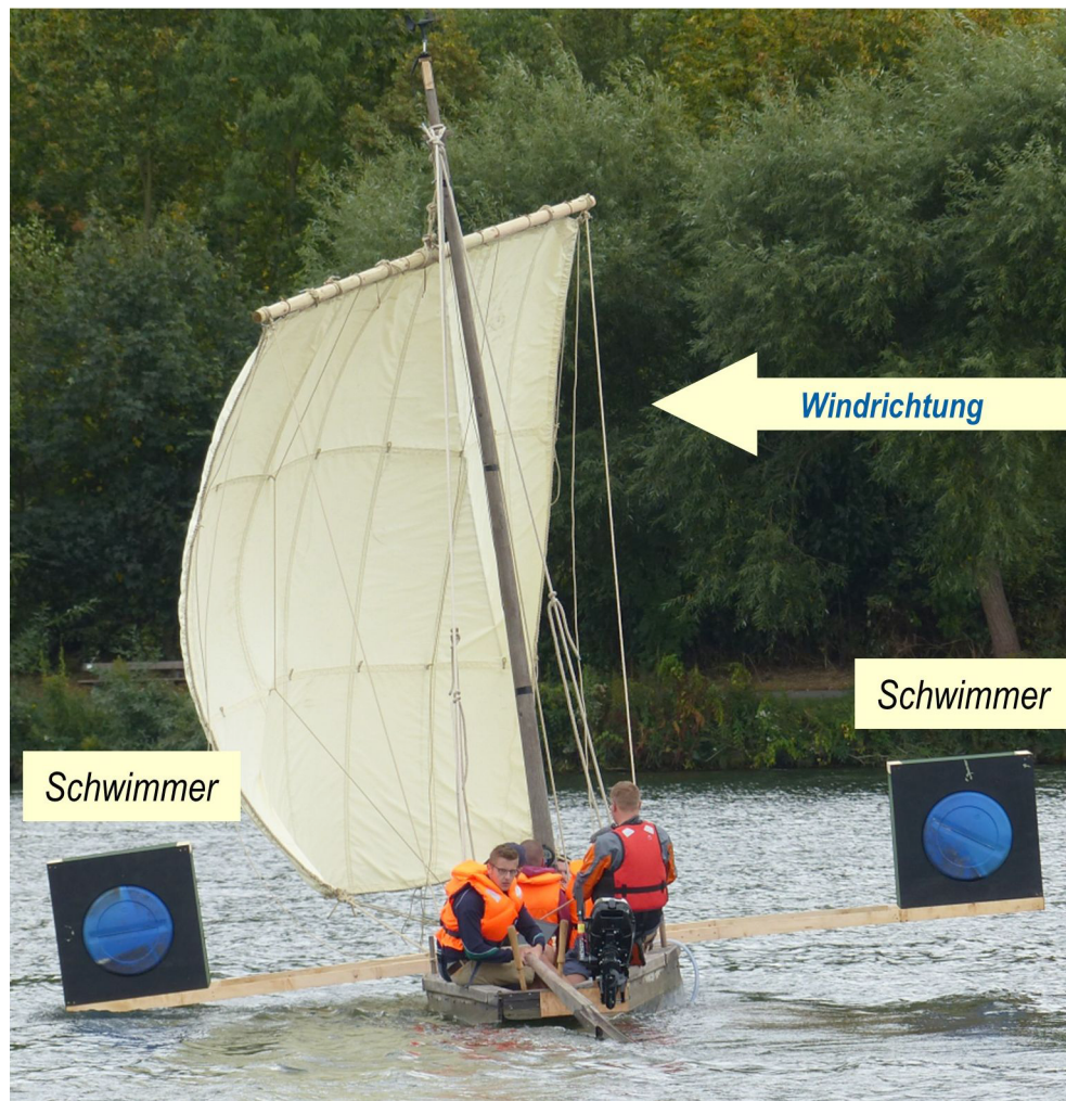
Abb. 7: Segeltests mit Kentersicherung.
