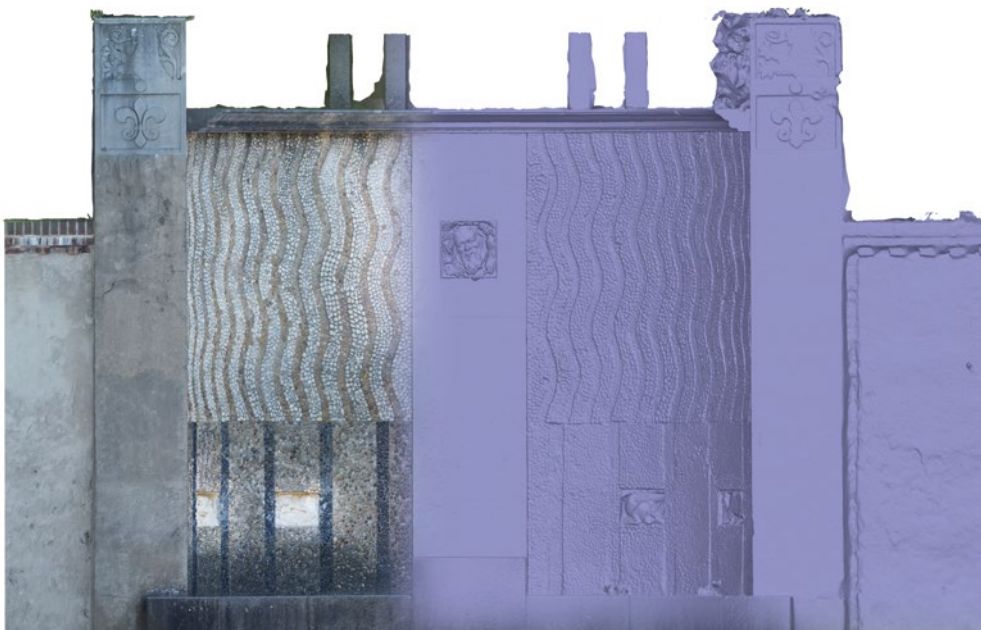
Abb. 2: Abbildung der resultierenden 3D-Modelle Modell mit fotorealistischer Textur (li.), Modell einfarbig mit reiner Oberflächenstruktur (re.) Foto: Ch. Seitz, LfDH
