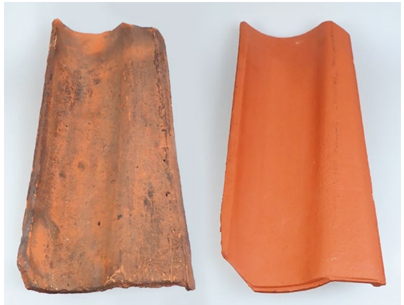
Abb. 7: Historischer Fittichziegel im Vergleich mit einem modernen frän- kischen Rinnenziegel Foto: C. Hopp, LfDH
