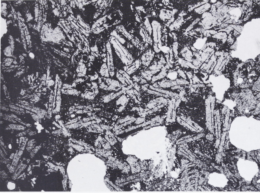
Abb. 65 Herbolzheim Tutschfelden (Kreis Emmendingen). Fayalit-Kristalle in der Eisenschlacke. Lange Bildkante 4,3 mm.
