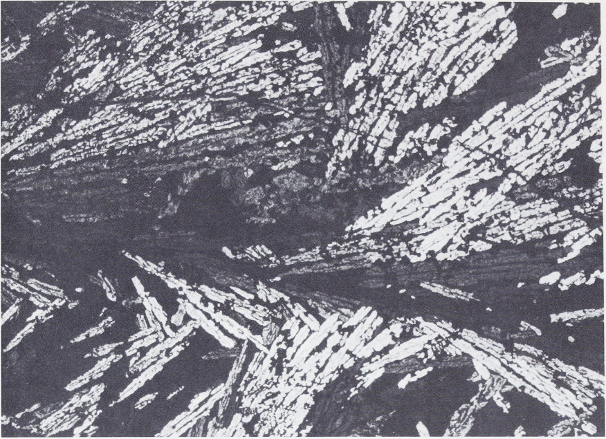
Abb. 67 Herbolzheim Tutschfelden (Kreis Emmendingen). Fächerwachstum von Pyroxferroit in der Eisenschlacke. Lange Bildkante 1,7 mm.
