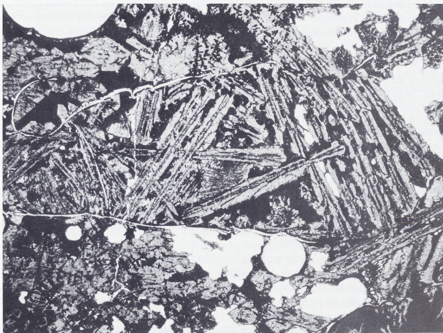
Abb. 64 Herbolzheim Tutschfelden (Kreis Emmendingen). Pyroxferroit-Leisten in der Eisenschlacke. Lange Bildkante 4,3 mm.
