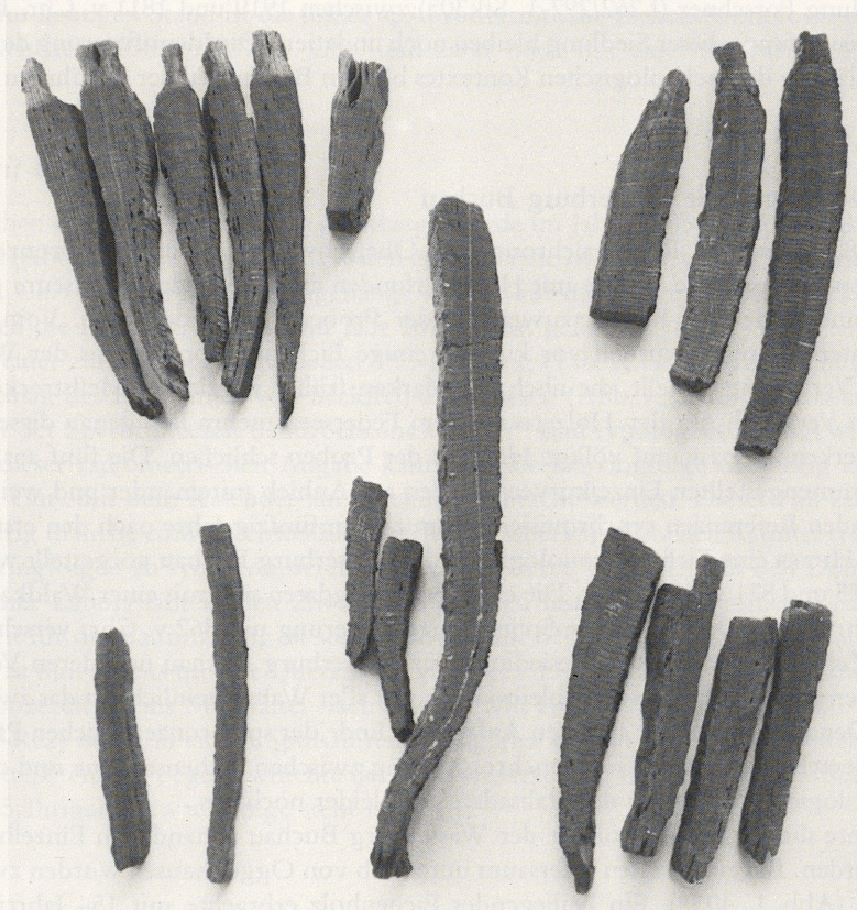
Abb. 4 Radial zugerichtete Eichenbretter aus der Wasserburg Buchau. Aus den zum Teil demselben Baumstamm zugehörigen Proben konnten fünf verschiedene Einzelkurven zusammengestellt werden. Bei dem größten Exemplar in der Bildmitte ist eine früher angelegte Meßstrecke erkennbar. Die Proben der oberen Reihe zeigen eine starke tangentielle Schwindung des Splintholzes.
