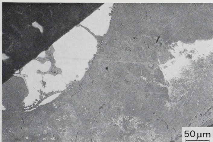
Abb. 22 Mikrogefüge der mittleren Einlage von Abbildung 20 mit Spuren der Mikroröntgenfluoreszenzanalyse, nicht geätzt.
