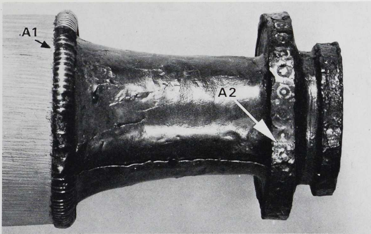
Abb. 1 Radnabe von Winterlingen, Kr. Balingen; mit Strich- und Kreis-Punkt-Einlegearbeit und Stellen der Probenahme (A 1 und A 2).
