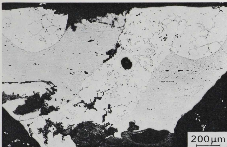
Abb. 32 Gefüge von zwei Einlagen des Dolches unbekannter Herkunft, nicht geätzt.
