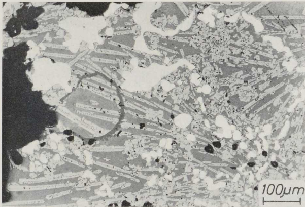
Abb. 19 Gefüge des unter Holzkohle umgeschmolzenen Schlackenstückes aus Grube 9.
