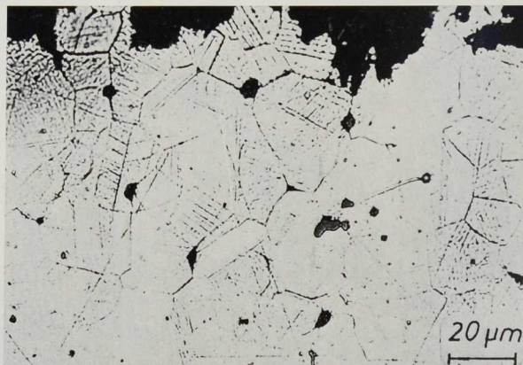
Abb. 10 Rekristallisiertes Gefüge der Zinnbronze des Armreifs aus Grube 20.
