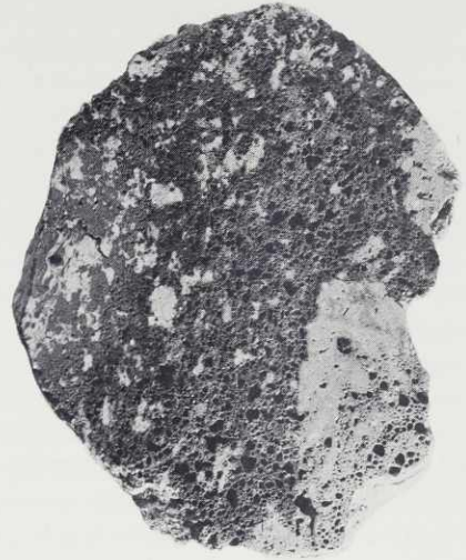
Abb. 2 Querschnitt durch eine bimssteinähnliche Schlackenknolle. Der Knollenkern zeigt eine schaumig-poröse, dunkelgrau reduzierte Zone mit glasig glänzenden Porenwänden. Er setzt sich deutlich ab vom stärker oxydierten gelbgrauen Knollenteil, der meist randlich liegt und weniger porös ist.
