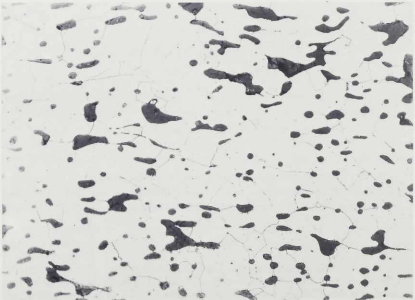
Abb. 2 Schlackenreiche Zone mit rein ferritischer Gefügeausbildung im Bereich der Probe 3 (vgl. Abb. 1). Ätzung: Nital. Maßstab 200:1.
