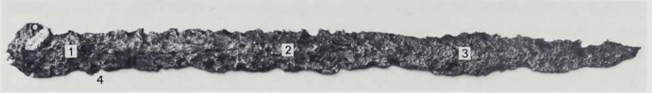
Abb. 1 Gesamtansicht des 530 mm langen und 430 g schweren Eisenschwertes von Singen/Hohentwiel. Die Probeentnahmestellen sind mit den Ziffern 1-4 gekennzeichnet.
