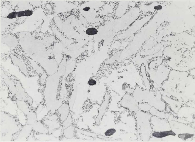
Abb. 4 Schmiedegefüge mit widmannstädtischer Grundstruktur. Der Zementit liegt in globularer Form vor. Ätzung: Nital. Maßstab 500:1.
