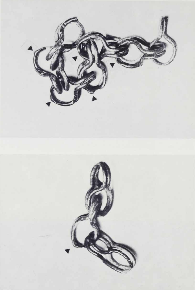
Abb. 11 Schweißperlen auf verschiedenen Kettengliedern. ► = Schweißperlen. Maßstab 2,5:1.
