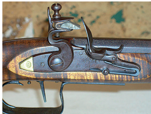
Abb. 290 Flinte mit Steinschloss und Silex als Schlagstein.
