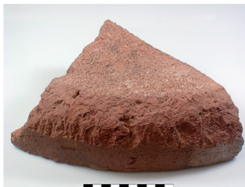
Abb. 281 Fundnr. 30, Backstein mit gerundeter Außenseite und rundlich abgeschlagener Kante.
