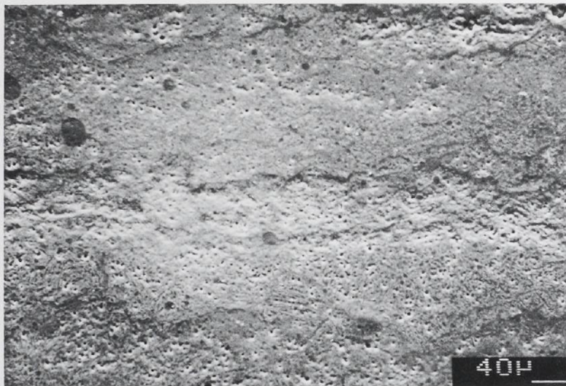
Abb. 9 Rasterelektronenmikroskopische Aufnahme eines Querschliffs durch das Spiegelbruchstück aus Grab 6 mit breit lamellarem Aufbau, ungeätzt. Bei der Schliffpräparation treten die härteren zinnreichen Bezirke, die vermutlich bei mehrfacher Zinn-Eindiffusion entstanden, aus dem Grundgefüge heraus.
