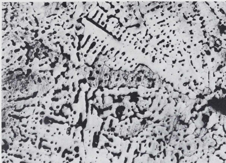
Abb.2 Schliff, ungeätzt, durch eine aus der Schlackenschicht des Tiegels isolierte Bronzekugel mit Kupfer-Zinn-Dendriten und Bleiausscheidungen. Vergrößerung 1:100.
