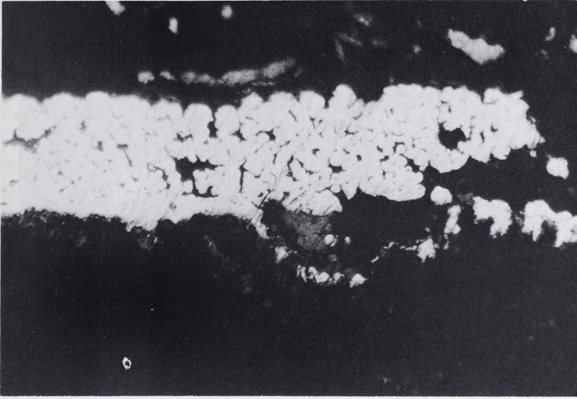
Abb. 22 Porige Feuervergoldungszone, ungeätzter Querschliff. Vergrößerung 1:500.
