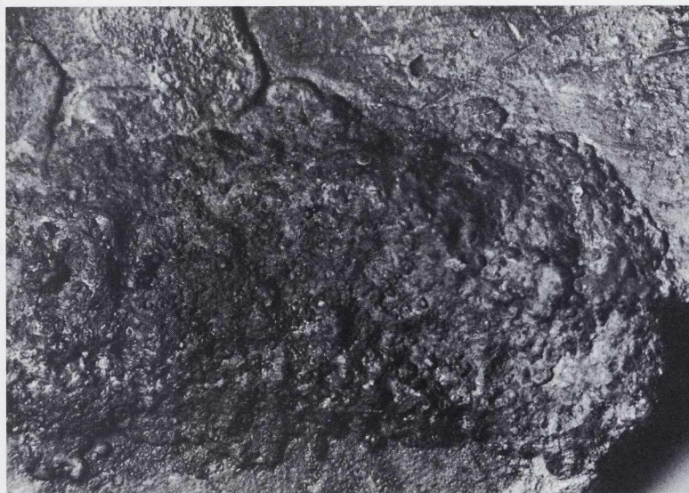
Abb. 16 Durch Überganguß erzeugte Verbindung. a) Nachgemeißelte Außenseite; b) unbearbeitete Innenseite. Vergrößerung 1:2.
