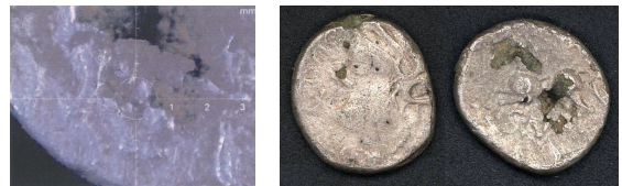
Abb. 21: ED-XRF Spektrum und Analyse des Kerns eines subaeraten KALETEDOU-Quinars. Durch die Korrosion (Fe) ist die Silberhülle aufgebrochen und der Münzkern ist sichtbar (Bild). Die Analyse zeigt auch hier deutlich Quecksilbergehalte, die auf Amalgamierung hinweisen. Inv.-Nr. 2004-50-354.
